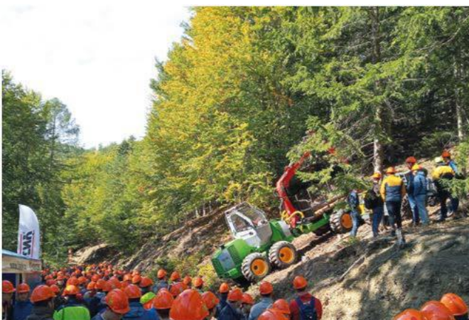
Forwarder LVS 520 mit der Traktionswinde
